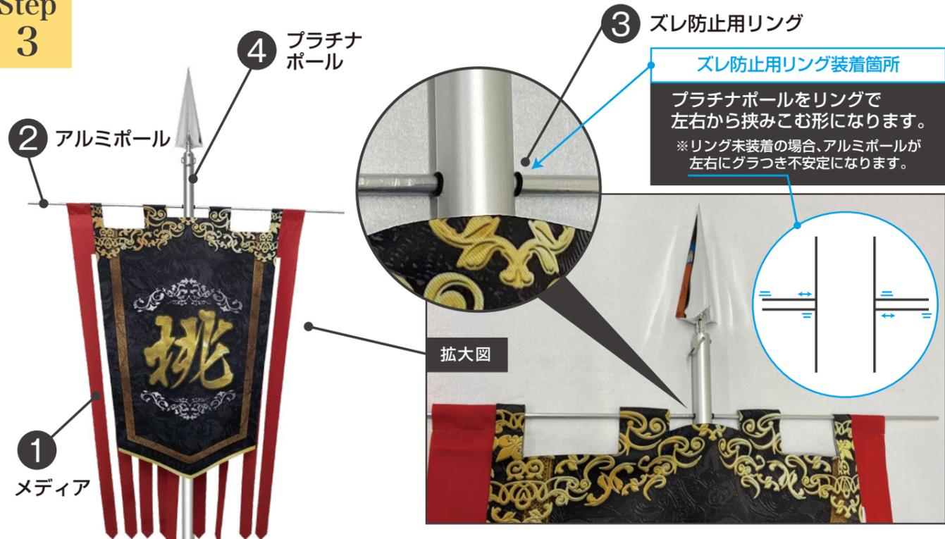
アルミポールがプラチナポール(穴)を通過した時点で、もう1個のスレ防止用リングをセットし残りの上部袋に通していきます。
