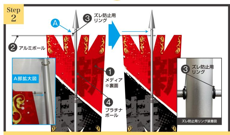
アルミポールにズレ防止用リングを装着しプラチナポール(穴)に通していきます。 穴を通過したら、反対側にもズレ防止用リングを装着します。
